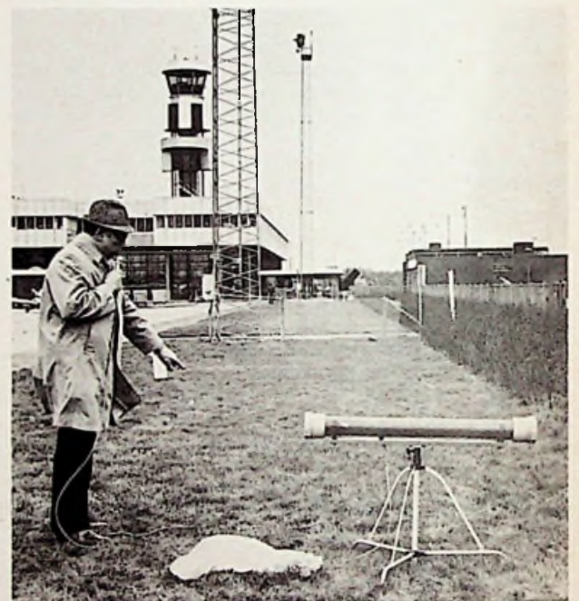
Afb. 2 Demonstratie van het beveiligingssysteem. Op de voorgrond de zender, ca. 80 m verderop de ontvanger (zie pijl). Tussen de zender en de ontvanger is een stuk gaas gespannen.
